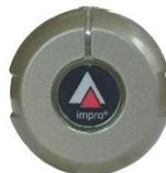
Lecteur de proximité Antenne métallique, compatible avec contrôleur de portes ImproX iTT et contrôleur système IXP20/IXP220. Pas de clavier, couleur nickel satiné, avec ronfleur, LED bicolore, boîtier en alliage de zinc moulé, L75 x H72 x P27 mm, IP53.
