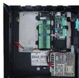
Cluster Controller avec 1 module Antenna – Boîtier métallique avec alimentation intégrée
