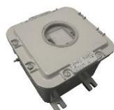
Détecteur MO industriel • Boîtier ATEX antidéflagrant pour montage extérieur • Doppler stéréo RADAR • Portée de détection: 30m x 13m • Hauteur de montage: 1.80-2.50m • Sensibilité de détection réglable via un commutateur 10 positions • Portée de détection réglable via un commutateur 10 positions • Sortie d'alarme NO/NF • Plage d'alimentation: 9-20 Vdc (150mA) • Dimensions (L x H x P): 225 x 255 x 259-334 mm
