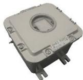
Détecteur MO industriel • Boîtier ATEX antidéflagrant pour montage extérieur • Doppler stéréo RADAR • Portée de détection: 30m x 13m • Hauteur de montage: 1.80-2.50m • Sensibilité de détection réglable via un commutation 10 positions • Portée de détection réglable via un commutateur 10 positions • Sortie d'alarme NO/NF • Plage d'alimentation: 9-20 Vdc (150mA) • Dimensions (L x H x P): 225 x 255 x 259-334 mm
