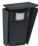
Détecteur IRP+MO industriel • Finition gris anthracite (RAL7016) • Élément IRP • Doppler stéréo RADAR • Portée de détection: 30m x 10m • Hauteur de montage recommandée: 2.00-4.00m • Analyse des mouvements stationnaires répétitifs tels que le mouvement de branches d'arbres ou d'arbustes • Analyse de la vitesse de déplacement pour éviter l'activation due aux oiseaux qui volent
