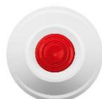
Bouton, panique ou émetteur contact sans fil ABAX2 • Bouton panique sans fil utilisé pour déclencher une alarme panique ou appeler à l'aide • Peut également être utilisé pour commander divers appareils (p. ex. appareils d'automatisation ou de contrôle d'accès) • Dimensions (dpx): ø97 x 29 mm • Pile CR14250 incluse ! A utiliser en combinaison avec l'émetteur-récepteur SA-ACU-220 ou SA-ACU-280.
