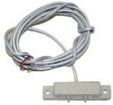
Détecteur de niveau d'eau. Fonctionnement par contact normalement fermé. Tension = 12Vdc. ATTENTION : Ne convient pas à une immersion complète dans l'eau !
