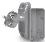
Kit de montage mural pour les détecteurs extérieurs SA-OPAL, SA-OPAL-PLUS, SA-OPAL-PRO et SA-AOD-200/210. Se compose de 2 supports pour montage mural : 1. Support mural pivotant • Réglable horizontalement sur 90° (maximum 45° à gauche et 45° à droite) • Réglable verticalement sur 60° (maximum 30° vers le haut et 30° vers le bas) • Plastique gris foncé 2. Support mural fixe • Pour montage fixe sous un angle de 45° • Plastique gris foncé
