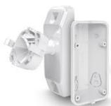
Kit de montage mural pour les détecteurs extérieurs SA-OPAL, SA-OPAL-PLUS, SA-OPAL-PRO et SA-AOD-200/210. Se compose de 2 supports pour montage mural: 1. Support mural pivotant • Réglable horizontalement sur 90° (maximum 45° à gauche et 45° à droite) • Réglable verticalement sur 60° (maximum 30° vers le haut et 30° vers le bas) • Plastique blanc 2. Support mural fixe • Pour montage fixe sous un angle de 45° • Plastique blanc
