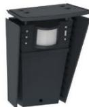
Détecteur IRP+MO industriel • Finition gris anthracite (RAL7016) • Élément IRP • Doppler stéréo RADAR • Portée de détection: 30m x 30m • Hauteur de montage recommandée: 2.00-4.00m • Analyse des mouvements stationnaires répétitifs tels que le mouvement de branches d'arbres ou d'arbustes • Analyse de la vitesse de déplacement pour éviter l'activation due aux oiseaux qui volent
