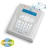
A500 PLUS Clavier + Prox + Audio • Affichage: LCD 32 caractères • Rétroéclairage bleu • 7 leds • touches programmables • 2 zones • Consommation au repos 70 ma • Lecteur de proximité Mifare • Haut-parleur pour guide audio • Dimensions : 110x130x34 mm • Compatibilité : centrales AVS Xtream, Capture, Raptor
