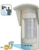
OUTSPIDER PA • détecteur digital extérieur 2 PIR • choix entre 4 lentilles 15m-90° animal alley 15m-90° 23m-5° 15m-5° • antimasking actif • buzzer et LED pour walk-test • usb pour liaison PC • Bus rs485 pour Xtream, Capture et XsatHP • 3 relais : alarmes, sabotages et antimasking, 1 sortie OC (lentille sale) , 2 entrées (aux et ON/OFF) • protection contre l'ouverture et l'arrachage • Température de fonctionnement : -20 C° + 55 C° • IP 65 • Dimensions (PxLxH) 135 x 140 x 240 mm
