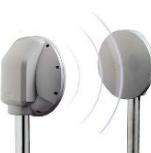
AVS BM 60 MW-WL • Barrière radar extérieure sans fils • FM 868 MHz • Portée 868 MHZ: jusqu'à 150 m • Données envoyées: alarme, sabotage,niveau batterie, self test • Portée radar : 60 m • 5 canaux • Alimentation: 230Vac/12Vdc • Batterie: 12Vdc 0,8Ah – non incluse • Dimension (LxHxD): 136 x 225 x 225 mm • Compatible with: CONCORDE PLUS WS -SATWS- XSATWS-XSATWS2 -INTWS-INTW4S
