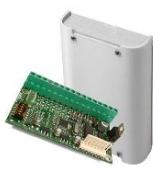
XSAT2 + CONT SX • 2 zones balancées + 2 avec fonction double zone (gestion de l'alarme de commutation ou des contacts inertiels disponible uniquement pour l'Xtream) • Sorties à collecteur ouvert: 16 • Connexion bus: RS485 • Tension d'alimentation: 13,8 Vdc • Consommation : 32 mA • Boîtier CONT SX 164x110x36 mm • Compatible avec: XTREAM 32/64/640, ADVANCE 88, CONCORDE 54
