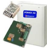
Alim XTREAM POWER3 3.4A PSU+PCB RS485 en boîtier métallique • Consommation: 3,4A max. (2 A pour chaque sortie d'alimentation, 1,4 A pour la batterie et la sirène) • Bus RS485 pour Xstream et Capture • Contrôle l'état du 230 VAC, des fusibles et de la batterie • Sortie d'état pour le SAT03 (compatibilité avec les anciens systèmes AVS) • Batterie : 12 Vdc de 7Ah à 17Ah • Compatibilité: centrales intrusion ADVANCE 88, CONCORDE 54, XTREAM, CAPTURE et aussi SAT03 • Boîtier métallique (330X420X104)
