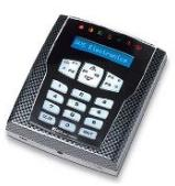
A500 CARBON Clavier LCD • Look CARBON • Affichage: LCD 32 caractères • Rétroéclairage bleu • 7 leds • touches programmables • 2 zones • Consommation au repos 70 ma • Dimensions : 110x130x34 mm • Compatibilité : centrales AVS Xtream, Capture, Raptor
