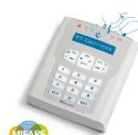
A500 PLUS WS4 FR • Clavier radio bi-directionnel 868 MHZ • Affichage: LCD 32 caractères • Rétroéclairage bleu • 7 leds • 2 zones/sorties • Alimentation : soit pile lithium ZB022 soit pile + alim (option) 13,8 VDC • Repeater de signaux radio si alimenté en 13.8 vdc • Lecteur de proximité Mifare • Haut-parleur pour guide audio en français • Dimensions : 110x130x34 mm • Compatibilité : Raptor
