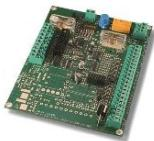
XSAT36 • Zones: de 10 à 18 (avec XEXP8) balancées, 36 avec fonction double zone (uniquement disponible pour la centrale Xtream) • Sortie relais: 1 • Sorties Open Collector: 8 • Connexion bus: RS485 • Contrôle des fusibles • Dimension: 80 x 130 mm • Compatible avec: XTREAM 32/64/640, CAPTURE, ADVANCE 88, CONCORDE 54
