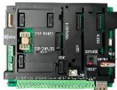
Platine mère d'une centrale ULTRA 64. • Equipée de base de 8 zones, extensible à 64 zones • Equipé d'une connexion multisocket IP • Maximum 16 partitions • 512 codes utilisateur • Journal de 5000 événements • Version Multilingue
