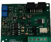
Module pour raccordement d'une ligne téléphonique analogique classique, à enficher sur la série de centrales AVS Ultra.
