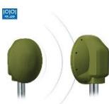
AVS BM 120 M-MW hp digitaal • Barrière radar extérieure • Connexion par: entrées et sorties ou BUS RS485 • Configuration par: bus RS485, USB ou directement dans l'appareil • Couloir d'alarme : 120 M - 3,0 x 3,0M • Mémoire d'alarme : 3600 événements • Détection de sabotage • Immunité aux petits animaux • Adaptation automatique aux conditions environnementales • Visualisation et évaluation du signal • Température de -20° à + 55°C • Résistance chauffante en option • IP34
