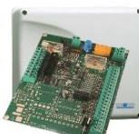
XSAT36 + CONT XTREAM • Zones: de 10 à 18 (avec XEXP8) balancées, 36 avec fonction double zone (uniquement disponible pour la centrale Xtream) • Sortie relais: 1 • Sorties Open Collector: 8 • Connexion bus: RS485 • Contrôle des fusibles • Boîtier métallique CONT XTREAM (HxLxP) 420x330x110 mm • Compatible avec: XTREAM 32/64/640, CAPTURE, ADVANCE 88, CONCORDE 54
