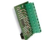
XEXP8 plug-in • Zones : 8 balancées + 8 avec fonction de zone double (management of switch alarm or inertial contacts only available for Xtream) • Consommation : 5mA • Dimension: 55x33 mm (LxH) • Compatible avec XTREAM 6/32/64 / 640, XSAT36, XSATPW
