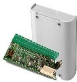
XSAT2 + CONT SX • 2 zones balancées + 2 avec fonction double zone (gestion de l'alarme de commutation ou des contacts inertiel disponibles uniquement pour l'Xtream) • Sorties à collecteur ouvert: 16 • Connexion bus: RS485 • Tension d'alimentation: 13,8 Vdc • Consommation : 32 mA • Boîtier CONT SX 164x110x36 mm • Compatible avec: XTREAM 32/64/640, ADVANCE 88, CONCORDE 54
