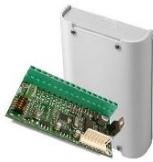
XSAT8+CONT SX • Zones: 10 balancées + 10 avec fonction double zone (disponible uniquement pour l'Xtream) • Sorties à collecteur ouvert: 8 • Connexion bus: RS485 • Tension d'alimentation: 13,8 Vdc • Consommation : 40 mA • Boîtier CONT SX 164x110x36 • Compatible avec: XTREAM 32/64/640, ADVANCE 88, CONCORDE 54
