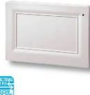
XSAT WS4 PRO • Récepteur sans fil bidirectionnel 868 MHz • 32 zones • 64 télécommandes • 1 sirène radio • Bus RS485 pour connexion à la centrale • 2 connecteurs programmables en entrée ou sortie • Alimentation 13,8 Vdc, courant MAX, 45 mA • Boîtier: 130x16x93 mm • Pour XTREAM & CAPTURE, seulement pour appareils radio WS4
