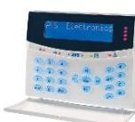
A600 EVO CLAVIER LCD GRANDS CARACTERES • LCD 32 grands caractères • Rétroéclairage bleu • Couleur: blanc • Zones: 2 • Touches de fonction pour armement rapide et/ou contrôle de sorties • Consommation: au repos 50 ma, max. 120mA • Dimension (LxHxD): 153 x 120 x 35 mm • Agrément: INCERT T031 • Compatible avec XTREAM - CAPTURE ET RAPTOR
