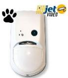
JET-PA WS4 VIDEO - Infrarouge passif avec lentille de Fresnel et zone basse - Portée IR : 15 mètres, ouverture 90°, 7 plans et 41 secteurs avec optique scellée - Immunité aux petits animaux - Antimasque par IR actif, distance de détection réglable - Accéléromètre pour signalisation arrachement et désorientation - Utilisation : à l'intérieur - Fréquence: FM 868 MHz - multicanal - bidirectionnel - Portée radio : jusqu'à 150 m. en champ libre - Communication : alarme-images avant et après
