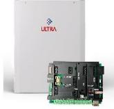
Centrale ULTRA 1000 en boîtier large métallique type-XL avec alimentation 50W-3,4A. • Equipée de base de 8 zones, extensible à 1000 zones • Equipé d'une connexion multisocket IP • Maximum 48 partitions • 1000 codes utilisateur • Journal de 10000 événements • Version Multilingue • Medium boîtier métallique de type-XL 380x490x110mm (LxHxP) avec alimentation 75W-5,0A et espace prévu pour une batterie de 7Ah, 12Ah ou 17/18Ah ou deux batteries de 17/18Ah
