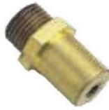
ER390 DIFFUSEUR POUR FOGGY 3 JET 90° • crée une diffusion de courte portée dans 3 directions différentes ; divise le jet dans 2 directions inclinées (une à 30° et • l'autre à 120°) et 1 droite (90°). • Ce type de buse permet l'installation du Foggy tout en créant un effet "rideau" dans le cas (par exemple) de protection de surfaces vitrées
