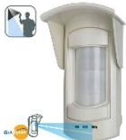
OUTSPIDER PA • détecteur digital extérieur 2 PIR • choix entre 4 lentilles 15m-90° animal alley 15m-90° 23m-5° 15m-5° • antimasking actif • buzzer et LED pour walk-test • usb pour liaison PC • Bus rs485 pour Xtream, Capture et XsatHP • 3 relais : alarmes, sabotages et antimasking, 1 sortie OC (lentille sale) , 2 entrées (aux et ON/OFF) • protection contre l'ouverture et l'arrachage • Température de fonctionnement : -20 C° + 55 C° • IP 65 • Dimensions (PxLxH) 135 x 140 x 240 mm
