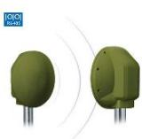
AVS BM 200 M-MW hp digital • Barrière radar extérieure • Connexion par: entrées et sorties ou BUS RS485 • Configuration par: bus RS485, USB ou directement dans l'appareil • Couloir d'alarme : 200 M - 3,0 x 3,0M • Mémoire d'alarme : 3600 événements • Détection de sabotage • Immunité aux petits animaux • Adaptation automatique aux conditions environnementales • Visualisation et évaluation du signal • Température de -20° à + 55°C • Résistance chauffante en option • IP34
