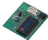
XSINT-FR module vocale • Connexion : plug-in • Français • Messages enregistrables : 40 max. 120 secondes • Messages préenregistrés : plus de 320 mots • Fonctionnement télécommande par téléphone avec guide d'aide vocal • Sortie audio : pour envoyer un message vocal aux claviers A600plus, A500plus, ICE • Compatible avec : XTREAM 6, 32, 64
