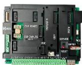
Platine mère d'une centrale ULTRA 1000. • Equipée de base de 8 zones, extensible à 1000 zones • Equipé d'une connexion multisocket IP • Maximum 48 partitions • 1000 codes utilisateur • Journal de 10000 événements • Version Multilingue
