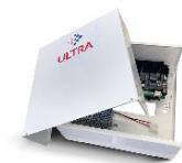
Centrale ULTRA 64 en boîtier medium métallique type-M avec alimentation 50W-3,4A. • Equipée de base de 8 zones, extensible à 64 zones • Equipé d'une connexion multisocket IP • Maximum 16 partitions • 512 codes utilisateur • Journal de 5000 événements • Version Multilingue • Medium boîtier métallique de type-M 275x305x90 mm (LxHxP) avec alimentation 50W-3,4A et espace prévu pour une batterie de 7Ah ou 12Ah
