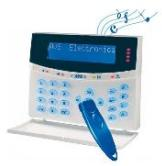
A600 EVO PLUS • LCD 32 grands caractères • Rétroéclairage bleu • Couleur: blanc • Zones: 2 • Touches de fonction pour armement rapide et/ou contrôle de sorties • Guide vocal • Lecteur de cartes Mifare • Consommation: au repos 85 mA, max. 250 mA • Dimension (LxHxD): 153 x 120 x 35 mm • Agrément: INCERT T031 • Compatible avec XTREAM CAPTURE ET RAPTOR
