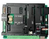
Platine mère d'une centrale ULTRA 128. • Equipée de base de 8 zones, extensible à 128 zones • Equipé d'une connexion multisocket IP • Maximum 24 partitions • 512 codes utilisateur • Journal de 10000 événements • Version Multilingue
