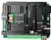
Platine mère d'une centrale ULTRA 32. • Equipée de base de 8 zones, extensible à 32 zones • Equipé d'une connexion multisocket IP • Maximum 8 partitions • 128 codes utilisateur • Journal de 5000 événements • Version Multilingue
