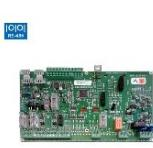
XSAT hp, • carte de gestion, 16/32 OUTSPIDER, BM-hp ou détecteurs bus AVS, 8 sorties extensibles à 16, 4 entrées & module pstn • raccordement possible via un bus RS485 aux centrales Xtream, Capture et Europanel et également via les sorties à n'importe quelle centrale. • permet la visualisation et la gestion à distance des appareils bus raccordés à l'aide du logiciel Xwin
