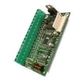
XSAT2 • 2 zones balancées + 2 avec fonction double zone (gestion de l'alarme de commutation ou des contacts inertiel disponibles uniquement pour l'Xtream) • Sorties à collecteur ouvert: 16 • Connexion bus: RS485 • Tension d'alimentation: 13,8 Vdc • Consommation : 32 mA • Dimension : 80x55 mm (LxH) • Compatible avec: XTREAM 32/64/640, ADVANCE 88, CONCORDE 54
