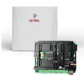
Centrale ULTRA 32 en petit boîtier PVC type-S avec alimentation 25W-1,7A. • Equipée de base de 8 zones, extensible à 32 zones • Equipé d'une connexion multisocket IP • Maximum 8 partitions • 128 codes utilisateur • Journal de 5000 événements • Version Multilingue • Petit boîtier plastique de type-S 275x275x99 mm (LxHxP) avec alimentation 25W-1,7A et espace prévu pour une batterie de 7Ah
