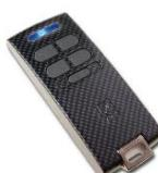
BIP4 PLUS C • Emetteur bidirectionnel 5 boutons, 8 canaux, 'carbon', 868MHz • Leds et buzzer pour indication de l'état de la centrale • Pour: X-SAT WS4, XSATWS4 PRO, ESPRIT, RAPTOR
