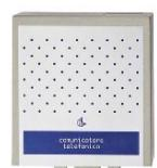
SINTECOM-4 transmetteur vocal autonome • Entrées: 4 • Messages: 4 • N° de téléphone: 6 • Consommation: 115mA • Dimension boîtier (LxHxD): 140 x 110 x 50 mm • la programmation se fait en connectant un téléphone DTMF
