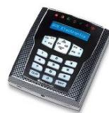
A500 WS4 CARBON • Clavier radio bi-directionnel 868 MHZ • Look CARBON • Affichage: LCD 32 caractères • Rétroéclairage bleu • 7 leds • 2 zones/sorties • Alimentation : soit pile lithium ZB022 soit pile + alim (option) 13,8 VDC • Repeater de signaux radio si alimenté en 13.8 vdc • Dimensions : 110x130x34 mm • Compatibilité : Raptor
