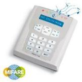
A500 PLUS Clavier + Prox + Audio • Affichage: LCD 32 caractères • Rétroéclairage bleu • 7 leds • touches programmables • 2 zones • Consommation au repos 70 mA • Lecteur de proximité Mifare • Haut-parleur pour guide audio • Dimensions : 110x130x34 mm • Compatibilité : centrales AVS Xstream, Capture, Raptor
