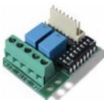
XMR2 - relais plug-in • Connexion: plug-in / flat cable (option) • convertit des sorties O.C. en contacts NO/NC • Consommation: 18 mA par relais • Corant max. admissible par un contact 1A @ 24 VDC • Dimension (LxHxD): 30x45x20 mm • Compatible avec tous les centraux et modules d'extensions
