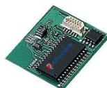
XSINT-NL module vocale • Connexion : plug-in • Néerlandais • Messages enregistrables : 40 max. 120 secondes • Messages préenregistrés : plus de 320 mots • Fonctionnement télécommande par téléphone avec guide d'aide vocal • Sortie audio : pour envoyer un message vocal aux claviers A600plus, A500plus, ICE • Compatible avec : XTREAM 6, 32, 64
