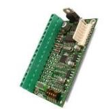
XSAT8 • Zones: 10 balancées + 10 avec fonction double zone (disponible uniquement pour l'Xtream) • Sorties à collecteur ouvert: 8 • Connexion bus: RS485 • Tension d'alimentation: 13,8 Vdc • Consommation : 40 mA • Dimension : 80x55 mm (LxH) • Compatible avec: XTREAM 32/64/640, ADVANCE 88, CONCORDE 54
