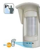
OUTSPIDER PA • détecteur digital extérieur 2 PIR • choix entre 4 lentilles 15m-90° animal alley 15m-90° 23m-5° 15m-5° • antimasking actif • buzzer et LED pour walk-test • usb pour liaison PC • Bus rs485 pour Xtream, Capture et XsatHP • 3 relais : alarmes, sabotages et antimasking, 1 sortie OC (lentille sale) , 2 entrées (aux et ON/OFF) • protection contre l'ouverture et l'arrachage • Température de fonctionnement : -20 C° + 55 C° • IP 65 • Dimensions (PxLxH) 135 x 140 x 240 mm
