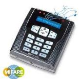
A500 CARBON PLUS Clavier + Prox + Audio • Look CARBON • Affichage: LCD 32 caractères • Rétroéclairage bleu • 7 leds • touches programmables • 2 zones • Consommation au repos 70 mA • Lecteur de proximité Mifare • Haut-parleur pour guide audio • Dimensions : 110x130x34 mm • Compatibilité : centrales AVS Xstream, Capture, Raptor
