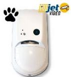
JET-PA WS4 VIDEO - Infrarouge passif avec lentille de Fresnel et zone basse - Portée IR : 15 mètres, ouverture 90°, 7 plans et 41 secteurs avec optique scellée - Immunité aux petits animaux - Antimasque par IR actif, distance de détection réglable - Accéléromètre pour signalisation arrachement et désorientation - Utilisation : à l'intérieur - Fréquence: FM 868 MHz - multicanal - bidirectionnel - Portée radio : jusqu'à 150 m. en champ libre - Communication : alarme-images avant et après
