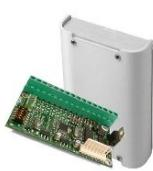
XSAT8+CONT SX • Zones: 10 balancées + 10 avec fonction double zone (disponible uniquement pour l'Xtream) • Sorties à collecteur ouvert: 8 • Connexion bus: RS485 • Tension d'alimentation: 13,8 Vdc • Consommation : 40 mA • Boîtier CONT SX 164x110x36 • Compatible avec: XTREAM 32/64/640, ADVANCE 88, CONCORDE 54
