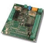
XSAT36 • Zones: de 10 à 18 (avec XEXP8) balancées, 36 avec fonction double zone (uniquement disponible pour la centrale Xtream) • Sortie relais: 1 • Sorties Open Collector: 8 • Connexion bus: RS485 • Contrôle des fusibles • Dimension: 80 x 130 mm • Compatible avec: XTREAM 32/64/640, CAPTURE, ADVANCE 88, CONCORDE 54
