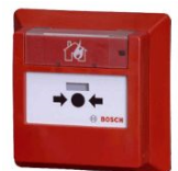
Rode LSNI drukknop voor analoge Bosch brandcentrales. Geïntegreerde kortsluitisolatoren. Onbreekbaar venster. Indicatie-LED. Half inbouw. Binnenmontage IP54. Conform EN54-11.
