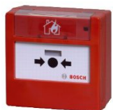
Rode LSNI drukknop voor analoge Bosch brandcentrales. Geïntegreerde kortsluitisolatoren. Onbreekbaar venster. Indicatie-LED. Inclusief opbouwdoos. Binnenmontage IP54. Conform EN54-11.
