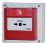
Rode LSNI drukknop voor analoge BOSCH brandcentrale. Geïntegreerde kortsluitisolatoren. Onbreekbaar venster. Indicatie-LED. Inclusief opbouwdoos. Buitenmontage IP67. Conform EN54-11.
