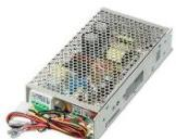
BAW75T24 alimentation pour système incendie • Vin 230 VAC-15% +10% 50/60Hz 110 VAC-15% +10% 60Hz • Vout 27,6 VDC 2.7 A max. • Chargeur de batteries pour max 2x 12V 17Ah • Protection contre les surcharges et les court-circuits • Dimensions 159 x 38 x 97mm
