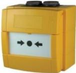
Bouton-poussoir étanche jaune conforme EN54-11, IP67, contact NO avec résistance 470 Ohm. Boîtier apparent avec 3 entrées de câble.
