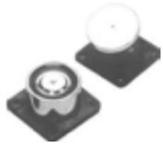
Electro-aimant 24VDC, 50kg, 45mA, avec diode, sans bouton de déblocage, HxLxP 65x65x36mm.
