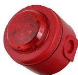
Sirène Solista avec flash led, lentille rouge 0,5Cd 1Hz, 32 tonalités, 102dB, 9-28VDC, 21mA, IP65, D93mm x H108mm, base profonde rouge incluse.
