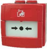
Bouton-poussoir incendie rouge EN54-11 intrinsèquement sécurisé Exia IIC T4 zone 0, 1 & 2. Complètement étanche IP67. Boîtier apparent comprenant 3 entrées de câble inclus. Vitre plexi incassable. Contact NO avec une résistance en série de 470 Ohm pour raccordement sur des centrales conventionnelles. Fonctionne avec isolateur MTL5061. Agréé ATEX Sira 06ATEX2131X.
