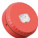
Flash led Solista LX pour montage au mur, lumière rouge, base basse rouge, 9-60VDC, 10-25mA, IP65, conforme EN54-23, couverture flash W-2,4-7,5, fréquence 0,5 ou 1 Hz, dimensions D93mm x H38mm.
