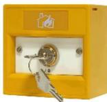
Commutateur à clé jaune à 2 positions, indication de fonction incendie. Clé uniquement amovible dans la position 0. Boîtier apparent inclus.
