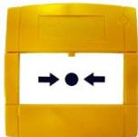
Bouton-poussoir jaune sans indication de fonction. Complètement étanche IP67. Boîtier apparent avec 3 entrées de câble inclus. Vitre plexi incassable. Contact NO ou NF.
