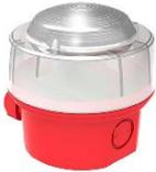
Flash led rouge pour montage sur plafond ou mur, socle rouge profond IP65, 32 tonalités conforme à EN54-3, 107dB, 12-29VDC, 49 mA, EN54-23, couverture flash W-2,4-6,3, C-3-9,3 ou C-6-8,5 fréquence 0,5 Hz; D100mm x H122mm, 293 g, connexion standard.
