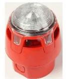
Sirène rouge avec flash led rouge classe ouverte pour montage au mur ou au plafond, socle profond, 32 tonalités conforme EN54-3, 107dB, 12-29VDC, 22 mA, IP65, EN54-23, couverture flash W-2,4-x, C-3-x, fréquence 0,5 Hz, D100mm x H122mm, 293 g, connexion First Fix.
