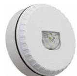
Flash led Solista LX pour montage mural, lumière blanche, base basse rouge, 9-60VDC, 10-25mA, IP65, conforme EN54-23, couverture flash C-3-7,5, fréquence 0,5 ou 1 Hz, dimensions D93mm x H38mm.
