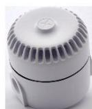
Sirène Roshni, blanche, 32 tonalités, 102dB, 9-28VDC, 16mA, IP65, D93mm x H93mm, base profonde incluse.
