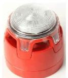
Sirène rouge avec flash led rouge pour montage au mur ou au plafond, socle bas, 32 tonalités, conforme à EN54-3, 107dB, 12-29VDC, 49 mA, IP21C, EN54-23, couverture flash W-2,4-6,0, C-3-8,9 et C-6-8,2, fréquence 0,5 Hz, D100mm x H98mm, 283 g, connexion First Fix.
