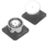
Electro-aimant 24VDC, 100kg, avec diode, 100 mA, sans bouton de déblocage, HxLxP 65x65x40,5mm.
