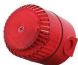
Flash Xénon Solex, Lentille rouge, Base profonde rouge, IP65, 10Cd, 10-60VDC 80mA, D93mm x H94mm.
