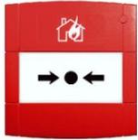
Bouton-poussoir incendie rouge EN54-11. BOSEC avec les centrales incendie HRZx. Complètement étanche IP67. Boîtier apparent comprenant 3 entrées de câble inclus. Vitre plexi incassable. Contact NO avec une résistance en série de 470 Ohm pour raccordement sur des centrales conventionnelles.
