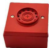
Sirène Askari, rouge, 32 tonalités, 97dB, 9-28VDC, 18mA, IP54, L86mm x L86mm x H42mm, boîtier apparent inclus.
