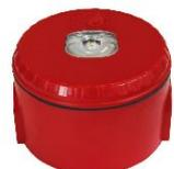
Flash led Solista LX pour montage au mur, lumière rouge, base profonde rouge, 9-60VDC, 10-25mA, IP65, conforme EN54-23, couverture flash W-2,4-7,5, fréquence 0,5 ou 1 Hz, dimensions D93mm x H65mm.
