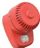
Sirène Roshni rouge avec flash led rouge pour montage mural, 32 tonalités, 102dB, 18-28VDC, 22-37 mA, IP65, conforme EN54-3 et EN54-23, couverture flash W-2,4-7,5, fréquence 0,5 ou 1 Hz, L95mm x H135mm x P95mm.
