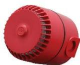
Sirène Roshni, rouge, 32 tonalités, 102dB, 9-28VDC, 16mA, IP65, D93mm x H93mm, base profonde incluse.
