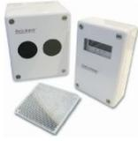
Détecteur beam pour 5 à 40 m. Se compose d'un contrôleur, émetteur-récepteur et réflecteur. Tension d'alimentation 10,2-30VDC; consommation 3,5 mA @ 24VDC. Sensibilité réglable, compensation automatique de l'encrassement et du mouvement du bâtiment. Choix de fréquence d'émission pour prévenir les interférences entre beams. Conforme à EN54-12, certifié VdS.
