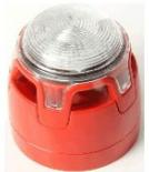
Sirène rouge avec flash led rouge classe ouverte pour montage au mur ou au plafond, socle bas, 32 tonalités, conforme EN54-3, 107dB, 24-29VDC, 22 mA, IP21C, EN54-23, couverture flash O-Wall-2,4-x et O-Ceiling-3-x, fréquence 0,5 Hz, D100mm x H98mm, 271g, connexion First Fix.
