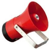
Sirène antidéflagrante Exd IIC T4 zone 1 et 2, BAS00ATEX2097X, 12-48VDC, 115dB, 27 tonalités, -20°C jusque + 70°C, IP66 & 67, 2 entrées de câble M20, finition rouge.
