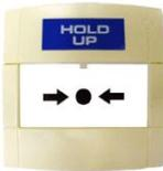
Bouton-poussoir blanc. Vitre plexi incassable. Contact NO ou NF. Le label Hold-up doit être commandé séparément si nécessaire.
