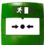
Bouton-poussoir vert avec symbole 'EXIT' Complètement étanche IP67. Boîtier apparent avec 3 entrées de câble inclus. Vitre plexi incassable. Double contact inverseur.
