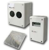
Détecteur beam anti-condensation pour 5 à 40 m. Se compose d'un émetteur-récepteur et réflecteur avec revêtement anti-condensation et d'un contrôleur. Tension d'alimentation 10,2-30VDC; consommation 3,5 mA @ 24VDC. Sensibilité réglable, compensation automatique de l'encrassement et du mouvement du bâtiment. Choix de fréquence d'émission pour prévenir les interférences entre beams. Conforme à EN54-12, certifié VdS.
