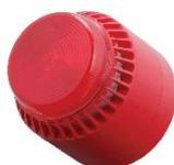
Sirène Flashni avec flash Xénon, lentille rouge, 0,7j, 1Hz, 2 tonalités, 90dB, 18-30VDC 68mA, IP65, D93mm x H121mm, base profonde rouge incluse.
