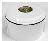
Flash led Solista LX pour montage au mur, lumière rouge, base profonde blanche, 9-60VDC, 10-25mA, IP65, conforme EN54-23, couverture flash C-3-7,5, fréquence 0,5 ou 1 Hz, dimensions D93mm x H65mm.
