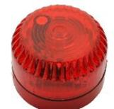
Flash Xénon Solex, Lentille rouge, Base basse rouge, IP54, 10Cd, 10-60VDC 80mA, D93mm x H64mm.
