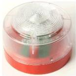
Flash avec led rouge pour montage au mur ou au plafond sur socle bas • Agréé BOSEC avec les centrales incendies HRZx, VSNx-2Plus et DXC • 12-29VDC 26 mA • IP21C • EN54-23 • couverture flash W-2,4-6,0, C-3-8,9 et C-6-8,2, fréquence 0,5 Hz • D100mm x H72mm • 195 g • connexion standard.
