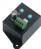
Aktieve ontvanger twisted pair, instelbaar 300-1500 m, 1 camera, 12VDC
