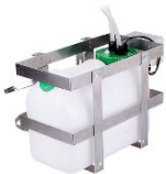
Bouw: Polyethyleen tank, roestvrijstalen kooi • Afmetingen: 405.5 x 194 x 267 (mm) • Capaciteit van de watertank: 10L • Bedrijfstemperatuur: 0 °C ~ 60 °C • Muur –of paalmontage
