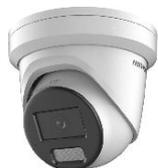
• Caméra réseau turrett Smart Hybrid Light ColorvU 4MP • Objectif fixe 2.8mm • WDR 130dB • Classification des personnes et des véhicules • IP67 • 12VDC/PoE
