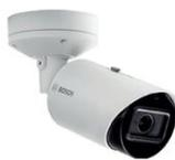
• DINION IP 3000i IR IP bullet • 1080p • J/N • 120dB WDR • 1/2.8-inch CMOS • 3,2-10mm • DC Iris F1.6 • AVF • H264 & H265 • 0.06 lx couleur/0.02 lx mono • 0,0 lx avec IR (Mesurée conformément à la norme IEC 62676 Part 5 (1/30, F1.6)) • CPP7.3 • Essential Video Analytics • IP66 • IK10 • IR: 30m • 12VDC/PoE • microSDXC • I/O: 1/1 • audio I/O
