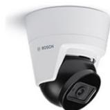
• FLEXIDOME IP Turret 3000i IR • 2MP HD 1080P • 100° • Intérieur • IR • Jour/Nuit • 0.06 lux Couleur/0.015 lux N/B • 0,0 lux avec IR (Mesurée conformément à la norme IEC 62676 PART 5 (1/30, F1.6 OR F2.2)) • 120DB WDR • 1/2.8 Inch CMOS • H.264/H.265 & MJPEG • MicroSDHC/MicroSDXC • IK08 • CPP7.3 • Essential Video Analytics • PoE/12 VDC
